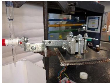
Figura 2. Placa de metal utilizada para fijar el motor en el anillo metálico.
